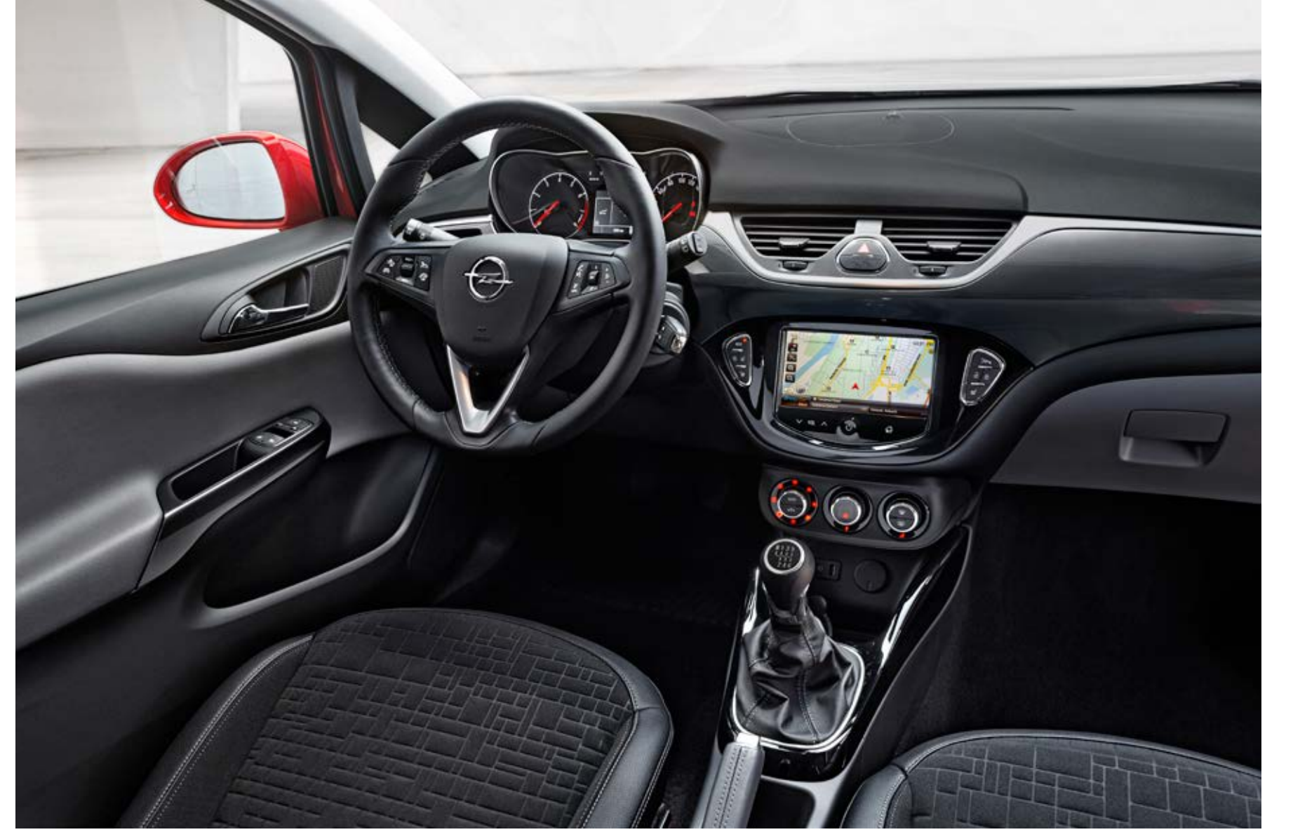
IntelliLink bilgi-eğlence sistemi, 7 inç renkli dokunmatik ekranı, Apple ve Android cihazlarla uyumlu olup sesli komut sistemi ile kullanılabilir.
